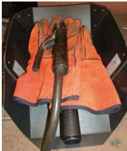
Abb. 4-2 Ohne Elektrodenrest isoliert abgelegter Stabelektrodenhalter
