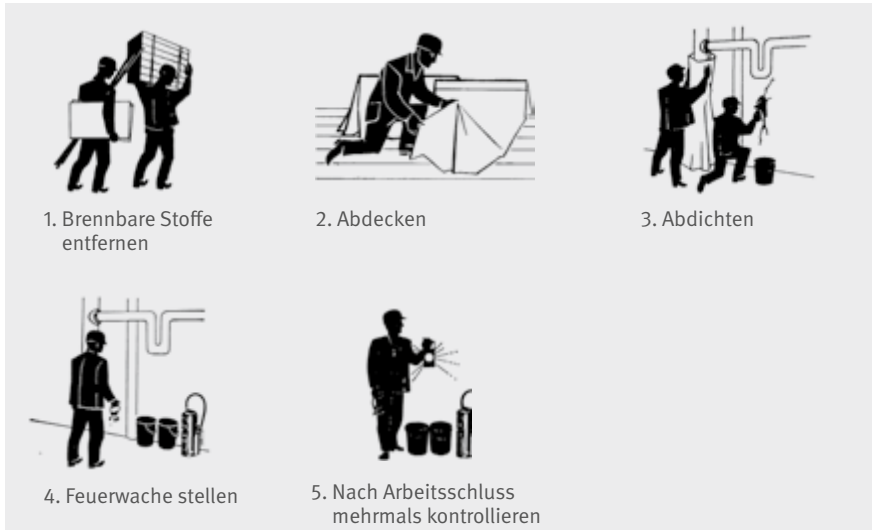
Abb. 8-3 Maßnahmen beim Schweißen unter Brandgefahr
