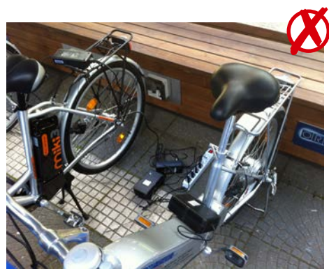
Abb. 18 Nicht empfehlenswert; Ladegeräte liegen auf dem Boden und sind über eine Mehrfachsteckdose unterverteilt (marktübliche Ladegeräte sind nur für die Benutzung in „trocknen Räumen“ geeignet)
