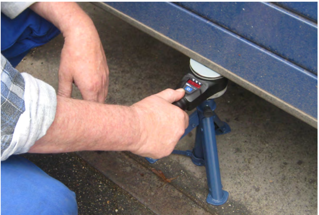
Abb. 25 Schließkraftmessung an der Hauptschließkante eines Torflügels
