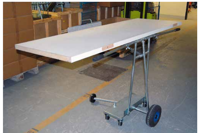
Abb. 32 Plattenschwenkwagen – Platte waagrecht geschwenkt
