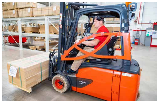
Abb. 24 Gabelstapler erst verlassen, wenn der Antrieb stillgesetzt, die Feststellbremse angezogen, die Gabeln auf den Boden abgesenkt und der Schlüssel abgezogen ist.
