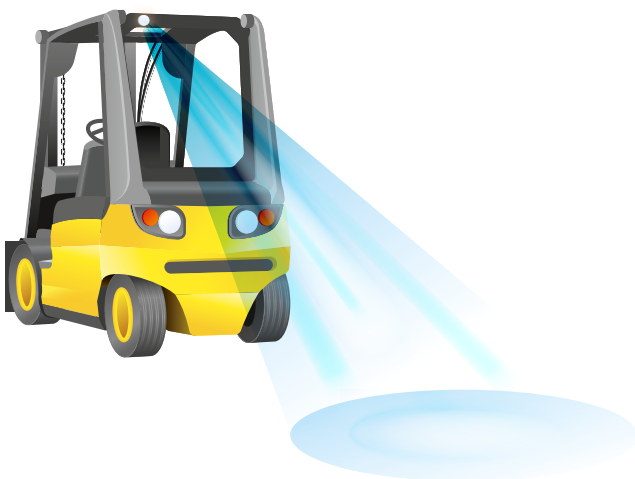
Abb. 41 Stapler mit optischer Fahrweg-Warneinrichtung
