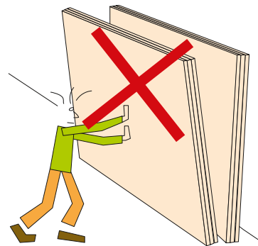
Abb. 51 Unzulässiges „Blättern“ in einem Plattenlager
