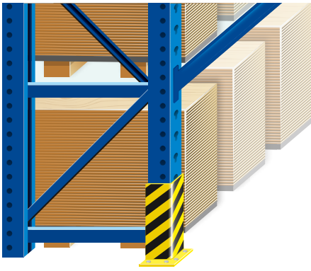
Abb. 65 Anfahrtschutz vor der Eckstütze eines Regals (Anfahrerenergieaufnahme mindestens 400 Nm)
