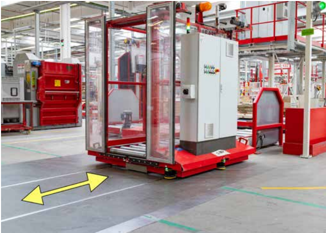
Abb. 86 Längsverschiebewagen mit Laserscanner
