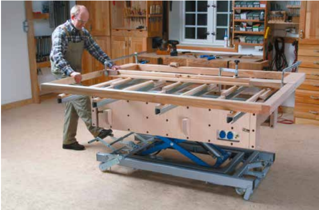
Abb. 33 Montagetisch, höhenverstellbar, auch zum Transport geeignet
