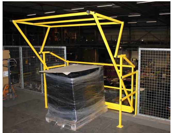
Abb. 78 Schleusengeländer – Stapler kann die Last aufnehmen, Geländer zur Lagerbühne geschlossen
