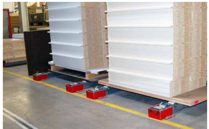
Abb. 70 und 71 Beispiele für Ablaufsicherungen an Rollenbahnen
