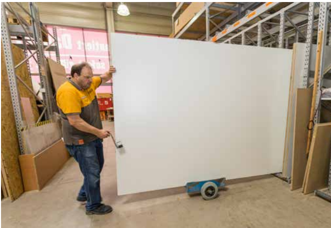
Abb. 25 Durch geeignete Tragegriffe können plattenförmige Werkstücke bequem erfasst und in günstiger Körperhaltung transportiert werden
