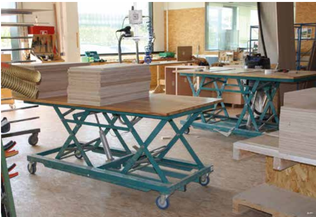
Abb. 34 Transporthubwagen mit Höhenverstellung
