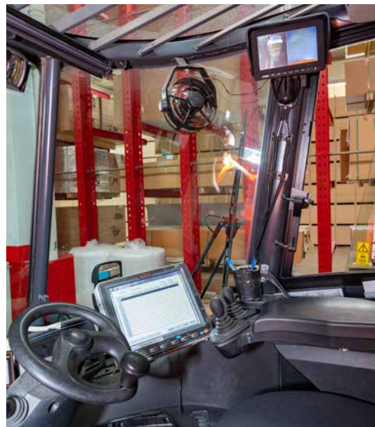
Abb. 39 Kamerasystem für Rückwärtsfahrt
