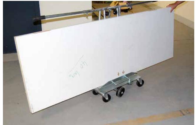
Abb. 31 Plattenschwenkwagen – Platte senkrecht in Transportposition
