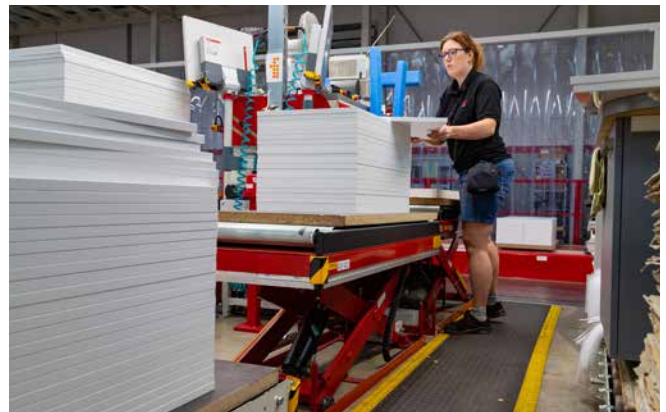
Abb. 6 Scherenhubtisch zur Anpassung der Arbeitshöhe
