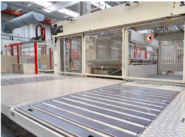
Abb. 14 Arbeitsbereich mit rutschfesten Standflächen und ausgekleideten Rollengängen
