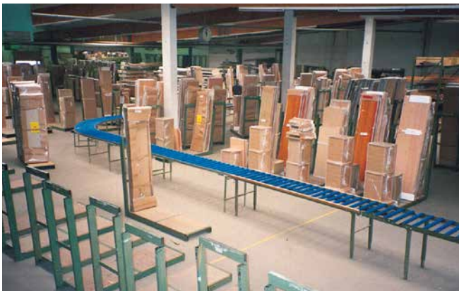
Abb. 2 Rollenbahn im Kommissionierbereich
