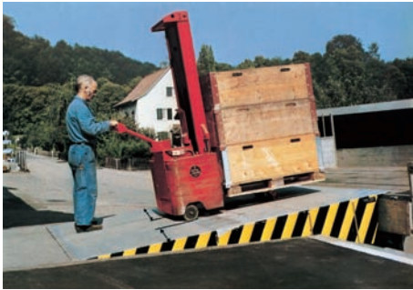
Bild 2: Ladebrücke in ausreichender Breite.
