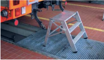
Das Abdecken nicht benutzter Teile von Arbeitsgruben ist immer die sicherste Lösung.
