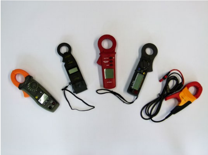
Abb. 39 Strommesszangen („Zangenampere- meter“); Einzel- geräte und Adapter
