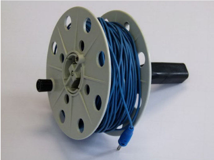
Abb. 45 Lange Messleitung auf Spindel für Schutzleiterwider- standsmessungen
