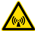
Bild 6 Warnzeichen W12 „Warnung vor elektromagnetischem Feld“
