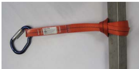
Abb. 34 Bandschleufe zur Schaffung eines Anschlagpunktes.
