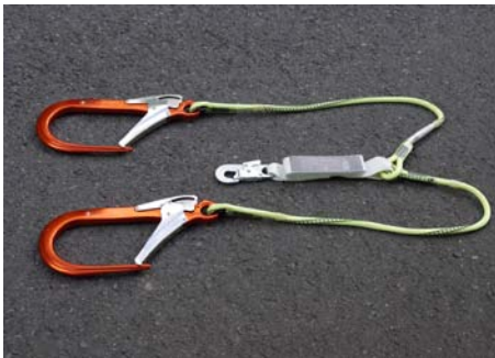
Abb. 26 Verbindungsmittel in Y-Ausführung („Y-Seil“) mit Falldämpfer zum gesicherten Wechseln von Anschlagpunkten.
