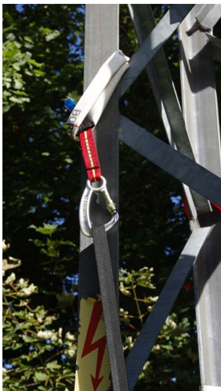
Abb. 37 Beispiel einer speziellen Bandschleufe für erhöhte Belastungen. Im Belastungsfall können Band- und Seilschlaufen durch Scherkräfte in Konstruktionsteilen übermäßig belastet werden. Es empfiehlt sich ein Einsatz speziell für diese Verwendung ausgewiesener Schlaufen.
