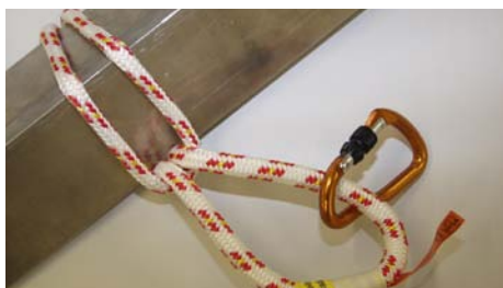
Abb. 35 Seilschleufe zur Schaffung eines Anschlagpunktes.
