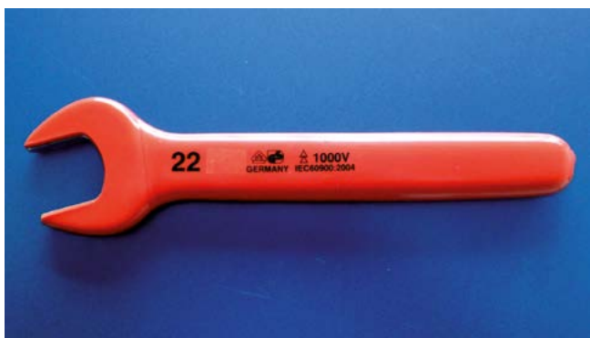
Bild 5-6: Vollisolierter Einmaulschlüssel für Arbeiten bis 1000 V
