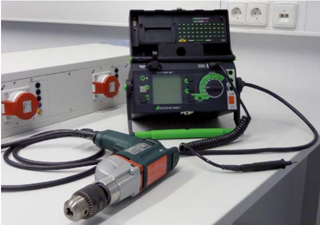
Bild 5-35: Prüfgerät für die Prüfung ortsveränderlicher elektrischer Betriebsmittel
