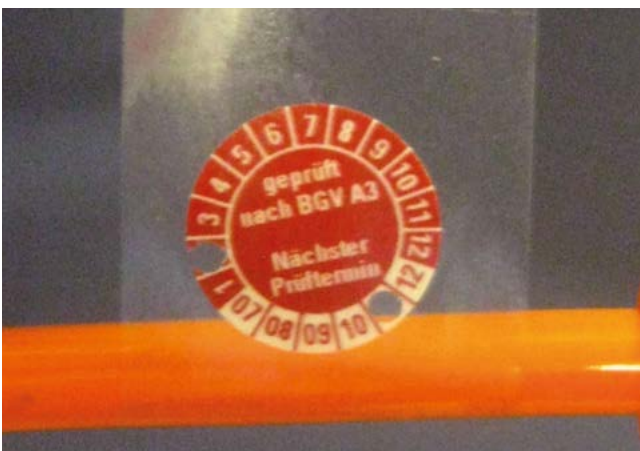
Bild 5-37: Beispiel für Prüfplakette
