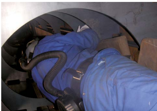
Bild 5-31: Beispiel für leitfähigen Bereich mit begrenzter Bewegungsfreiheit
