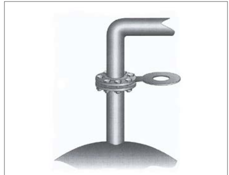
Abb. 18 Abtrennen mittels Steckscheibe
