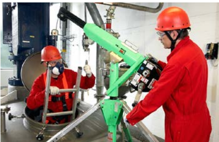
Abb. 22 Rettungswinde mit integrierter Absturz-sicherung
