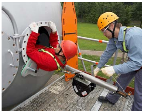
Abb. 26 Seiteneinstieg mittels spezieller Halterung des Rettungshubgerätes
