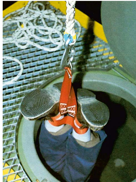
Abb. 28 Rettungsschleufe (besonders geeignet zum schnellen Retten)
