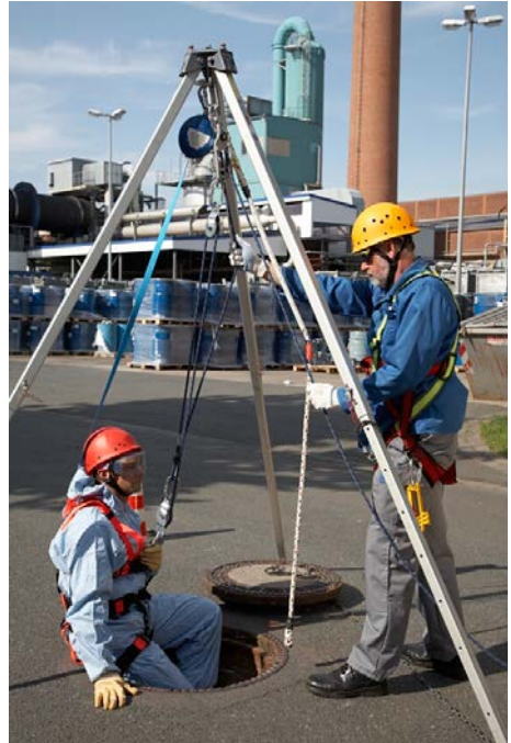
Abb. 23 Rettungshubgerät mit zusätzlichem Höhensicherungsgerät als Schutz gegen Absturz
