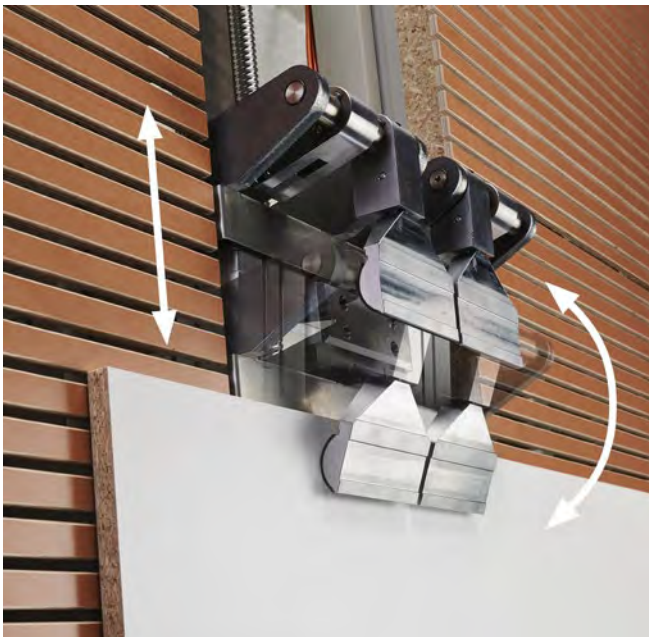
Abb. 3.1.2-04 Klemmvorrichtung für Besäumschnitt
