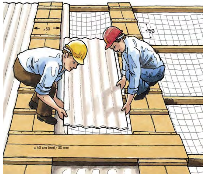
Abb. 3.5.2-04 Dachdeckung mit Wellplatten
