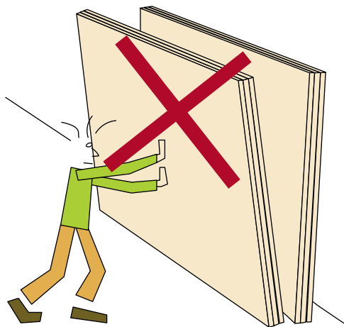
Abb. 3.4.3-02 Unzulässiges „Blättern“ in einem Plattenlager
