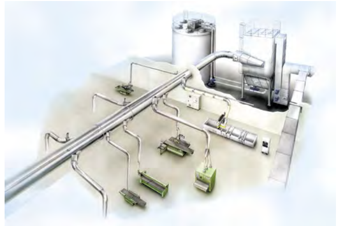
Abb. 2.2.3-02 Komponenten und prinzipieller Aufbau einer Absauganlage
