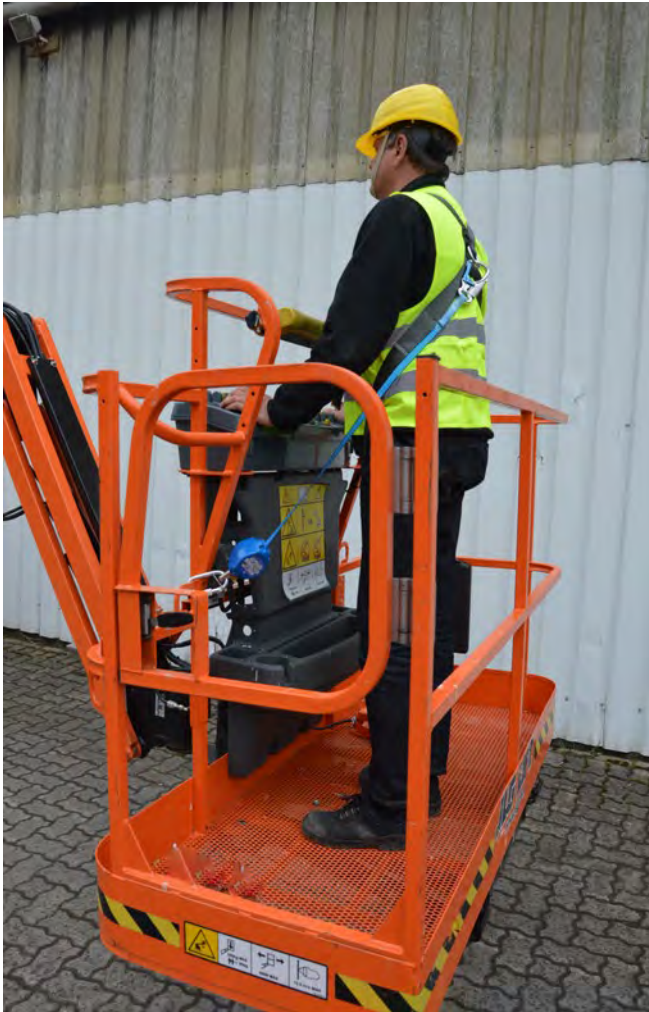
Abb. 3.5.4-02 Einsatz eines Höhensichtungsgeräts im Arbeitskorb
