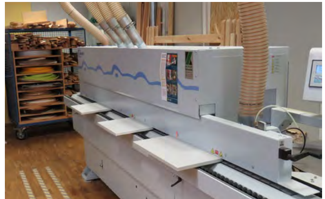
Abb. 3.1.12-04 Kantenanleimmaschine mit Absauganschlüssen
