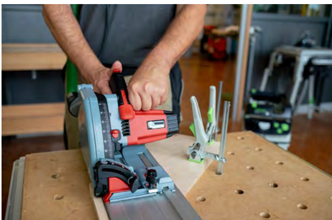
Abb. 3.3.1-10 Sägevorgang mit sicher fixiertem Werkstück
