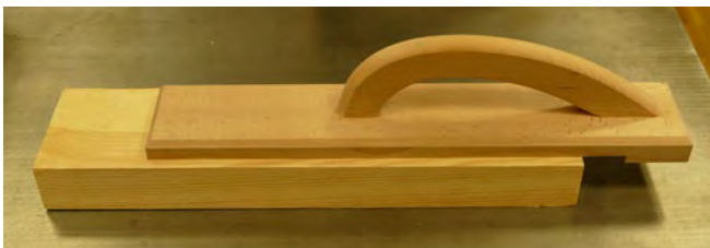
Abb. 3.1.9-05 Zuführlade und Schiebeholz für kurze Werkstücke
