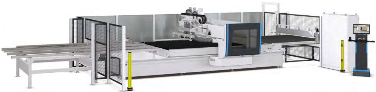
Abb. 3.1.11-01 CNC-Bearbeitungszentrum mit Schutzzaun und Kontakttrittmatte
