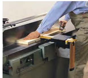
Abb. 3.1.9-07 Schwenkbarer Hilfsanschlag (Abrichten schmaler Leisten)
