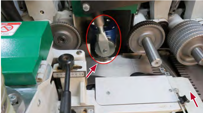
Abb. 3.1.13-03 Verdeckung einer hinteren Vertikalspindel vorge-setzter Druckrolle
