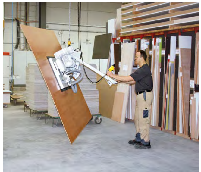
Abb. 3.1.2-08 Vakuum-Hebegerät für das Plattenhandling
