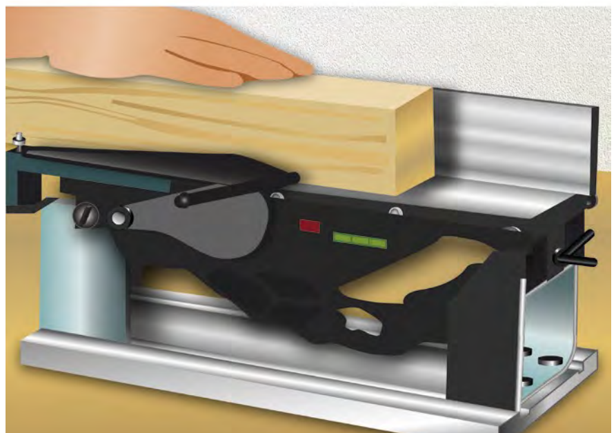
Abb. 3.3.3-02 Elektrohandhobel in stationärer Aufnahme
