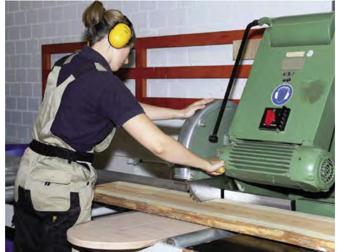
Abb. 3.1.5.06 Handhaltung beim Sägevorgang an einer Pendelkreissägemaschine
