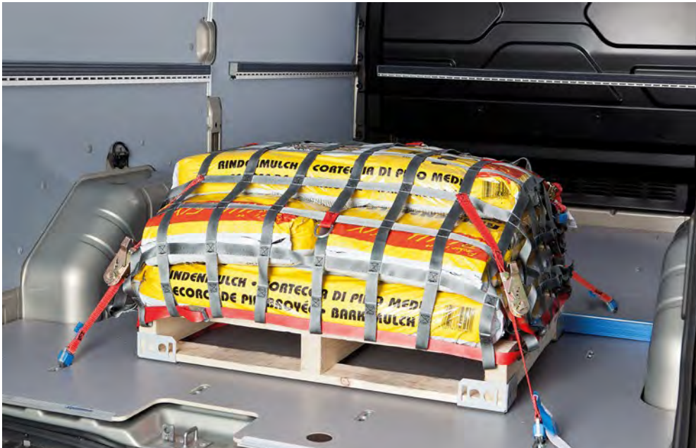
Abb. 3.5.6-02 Niederzurren eines freistehenden Ladungsguts
