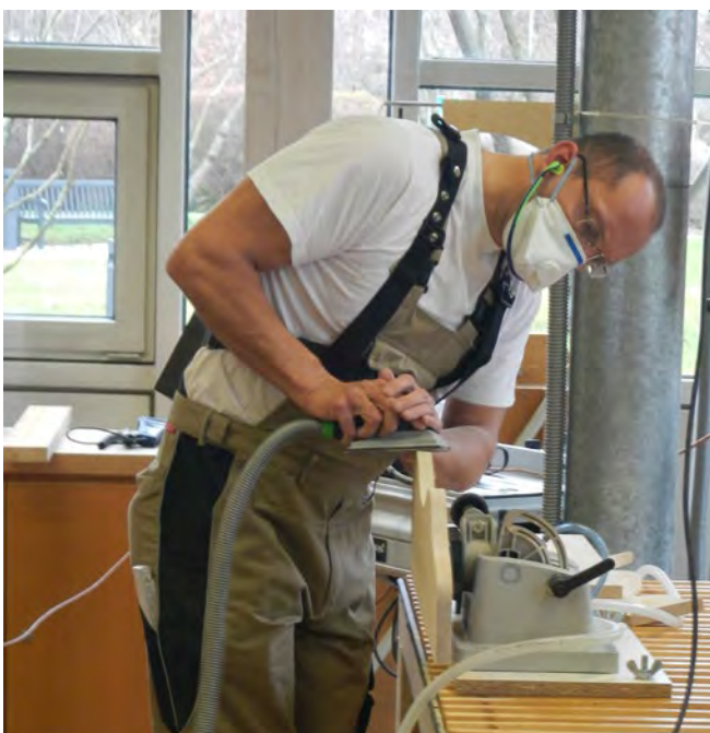
Abb. 2.2.3-07 Arbeiten mit Schutzmaske
