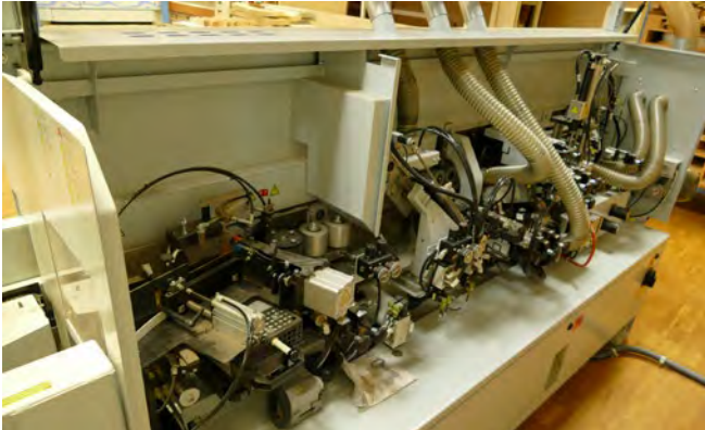
Abb. 3.1.12-02 Maschine mit geöffneter Schutzhaube (Kappsägeaggregate)
