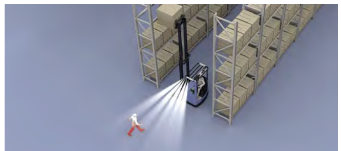
Abb. 3.4.4-04 Personenerkennung in einem Schmalganglager
