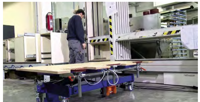
Abb. 3.1.15-07 Fahrbarer Bestückstisch zur Handhabung von großen, schweren Werkstücken
