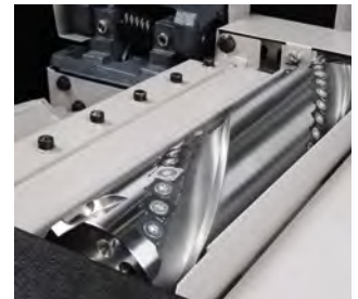
Abb. 3.1.9-08 Spiralhobelmesserwelle mit Einwegwendemessern
