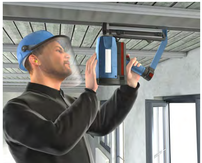
Abb. 3.3.7-03 Eintreibgerät mit Auslösesicherung
