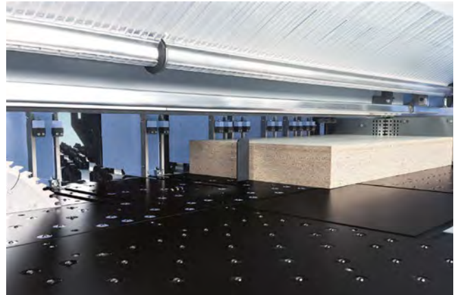
Abb. 3.1.3-02 Hohes Plattenpaket mit Winkelandrückvorrichtung
