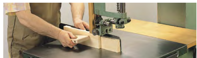
Abb. 3.1.6-10 Sägen kurzer Werkstücke mit Zuführhilfe
