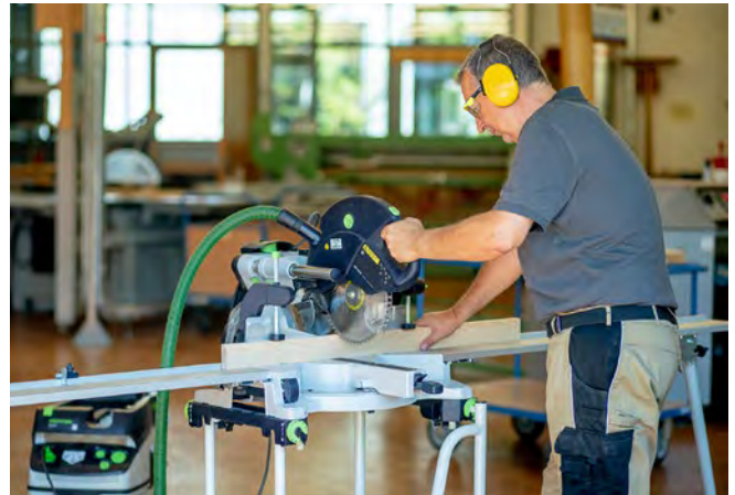
Abb. 3.1.4-02 Mobile Kapp-/Gehrungskreissägemaschine mit zusätzlicher Werkstückauflage
