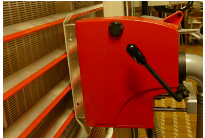
Abb. 3.1.2-05 Druckschuh und Bedienhebel
