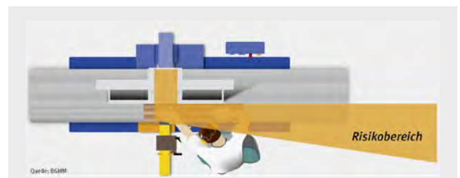
Abb. 3.1.9-02 Risikoaufenthaltsbereich an einer Abrichthobelmaschine
