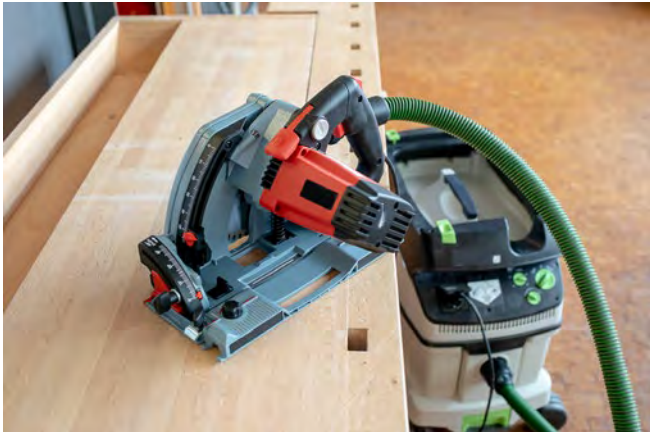
Abb. 3.3.1-09 Handkreissäge mit Absaugung
