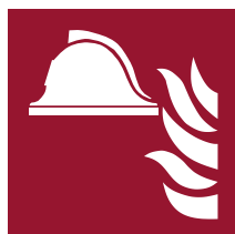
f004 Mittel und Geräte zur Brandbekämpfung
