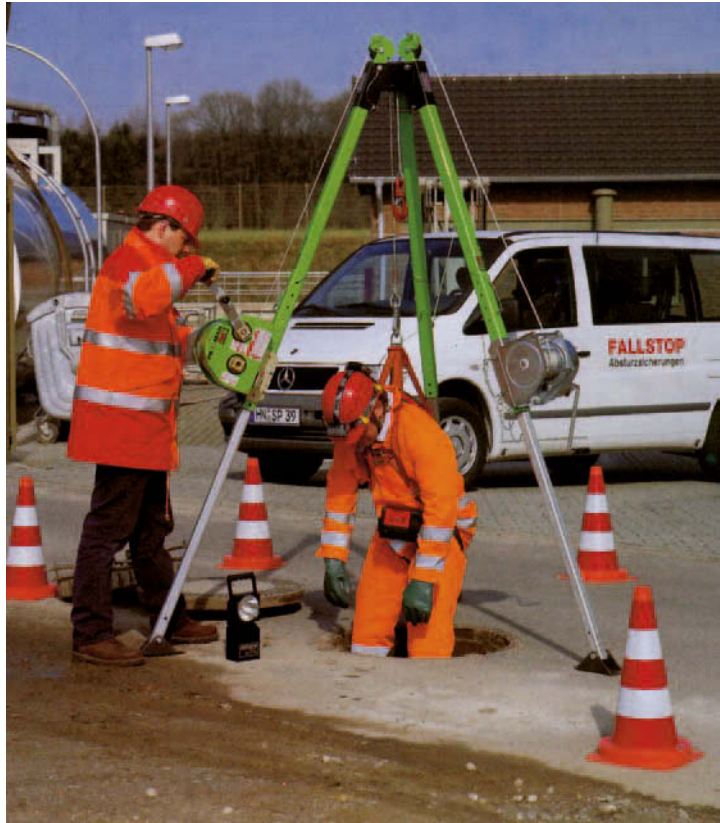
Bild 18: Rettung aus einem Schacht
